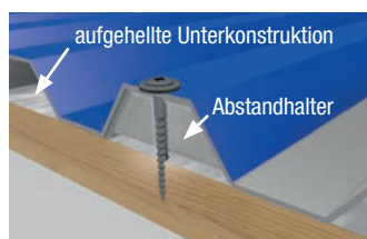
Querschnitt Befestigung der Überlappung
