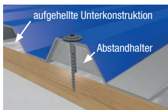
Querschnitt Befestigung der Überlappung
