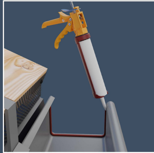
Abdichtung des Rinnenendes mit einer geeigneten Dichtungsmasse - Auftragen des Klebers am Ende der Rinne.
