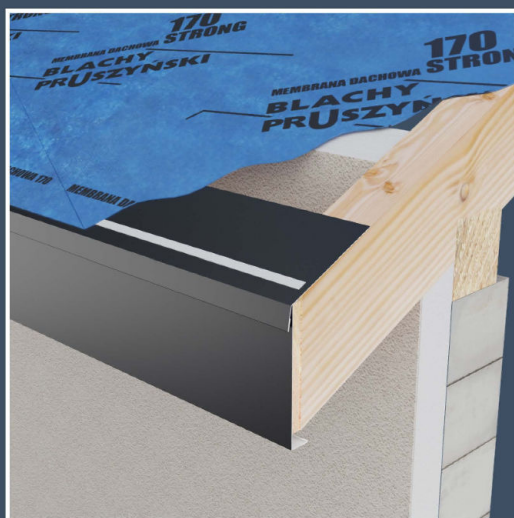
Aufkleben der Dachbahn über dem Dachrinnenblech und dem Dachsparren.
